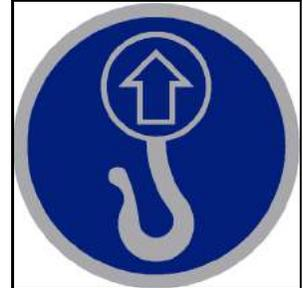
FIGURA 3-1. ETIQUETA DE IDENTIFICACIÓN DEL PUNTO DE ELEVACIÓN
