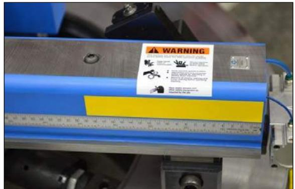
**FIGURA 3-19. METRO DEL BRAZO DE MECANIZADO**
