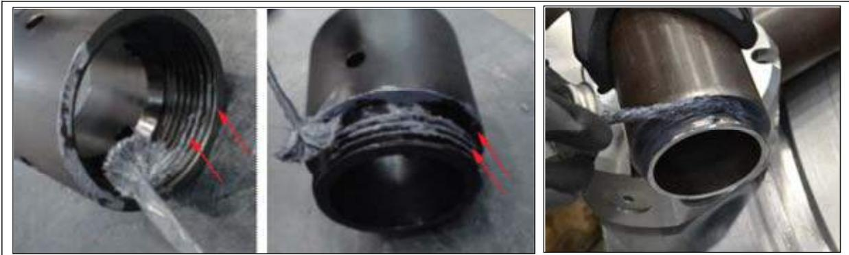
FIGURA 3-26. PUNTOS DE APLICACIÓN DE ANTIADHERENTE
