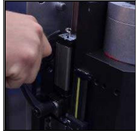
**FIGURA 3-60. AJUSTE DEL TORNILLO DEL EJE Y**
