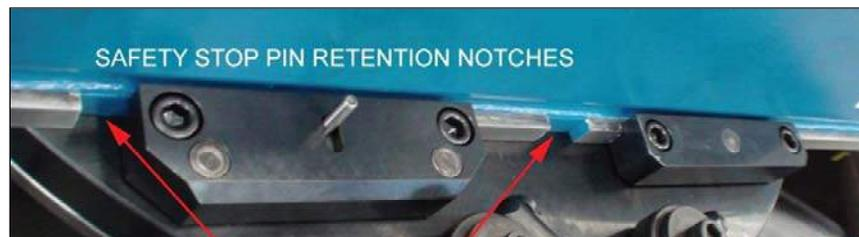
FIGURA 3-17. MUESCAS DE RETENCIÓN DEL PASADOR DE TOPE DE SEGURIDAD
