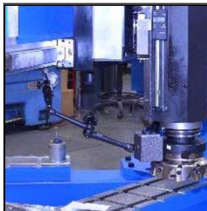
**FIGURA 3-56. INSTALACIÓN DEL INDICADOR DE CUADRANTE**
