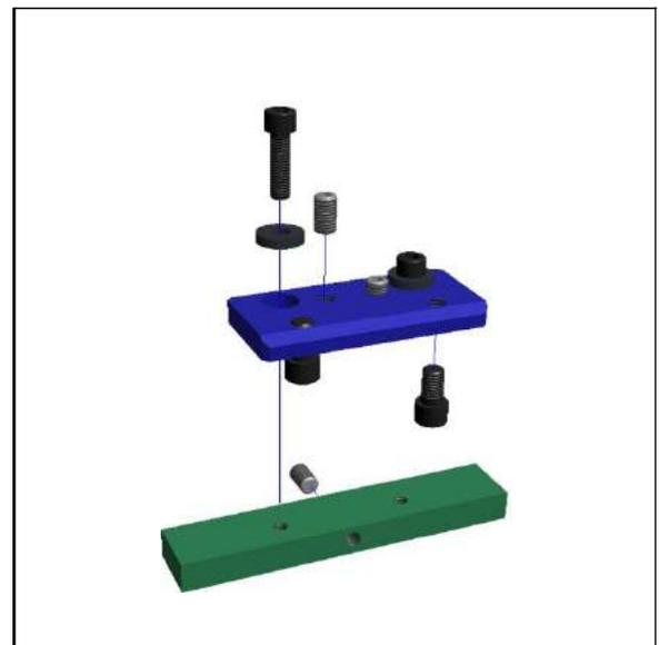
**FIGURA 3-38. ACOPLAR PLACA DE SOLDADURA DE TACHUELA**
