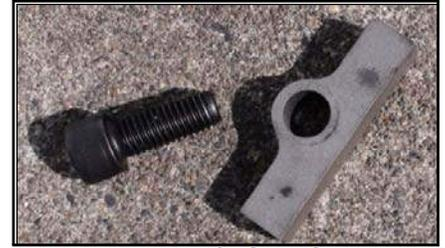
FIGURA 3-3. PLACAS DE SEGURIDAD DE SOLDADURA
