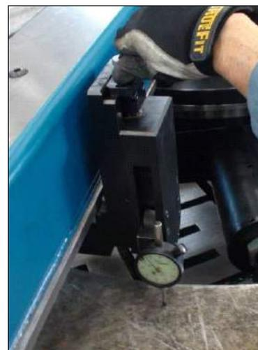
**Рис. 3-28. РАСПОЛОЖЕНИЕ ЦИФЕРБЛАТНОГО ИНДИКАТОРА**
