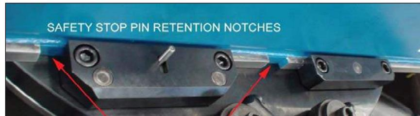
**Рис. 3-17. ПАЗЫ ФИКСАЦИИ ПРЕДОХРАНИТЕЛЬНОГО СТОПОРНОГО ШТИФТА**
