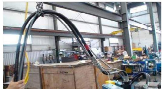
Рис. 4-1. ПРИМЕР ЗАКРЕПЛЕНИЯ ШЛАНГОВ
