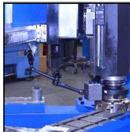
**Рис. 3-56. Установленный циферблатный индикатор**
