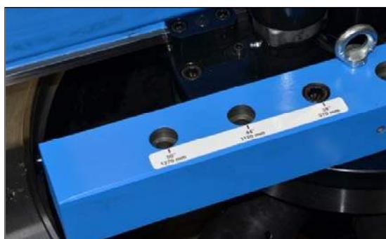
Рис. 3-21. Крепления противовеса
