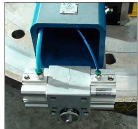
Рис. 3-30. Линии подачи воздуха коробки подач
