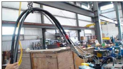
Рис. 4-1. ПРИМЕР ЗАКРЕПЛЕНИЯ ШЛАНГОВ
