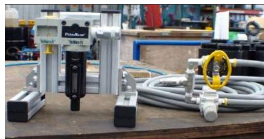
Рис. 4-2. КОНФИГУРАЦИИ ПНЕВМАТИЧЕСКОГО БЛОКА (ВАРИАНТ 1 СЛЕВА И ВАРИАНТ 2 СПРАВА)
