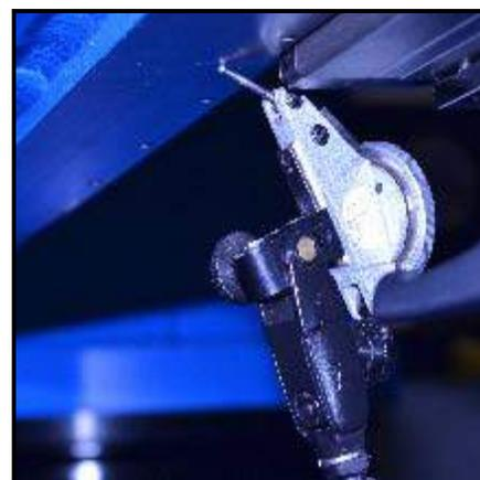
**Рис. 3-57. Контакт между индикатором и поверхностью хобота станка**
