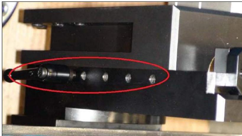
Рис. 3-13. ШЕСТЬ ВИНТОВ М6
