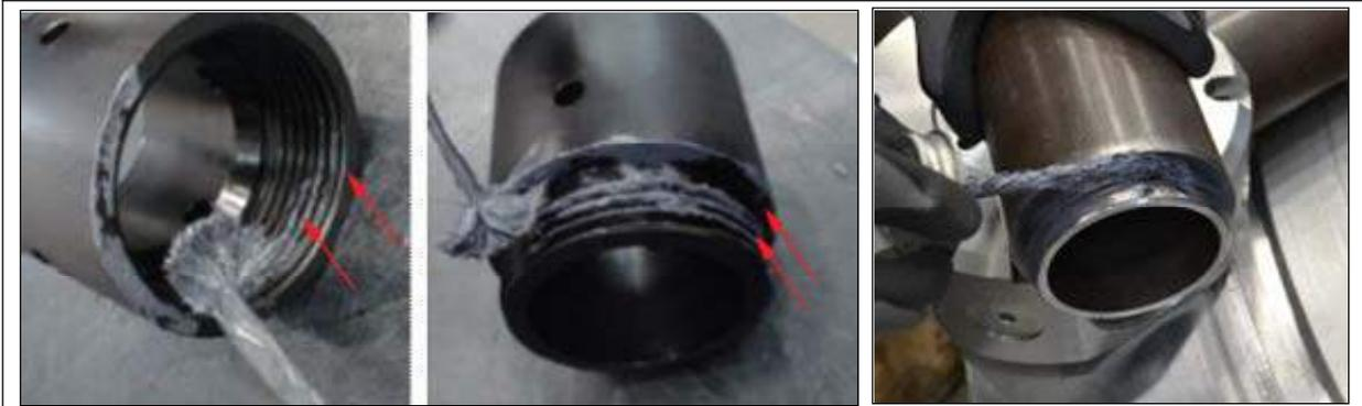
Рис. 3-26. Зоны нанесения противозадирной смазки
