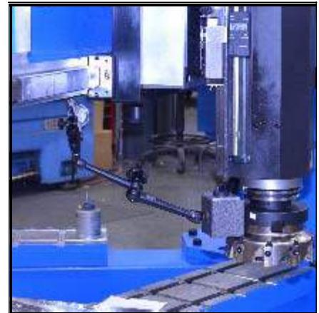
Рис. 3-56. Установленный циферблатный индикатор
