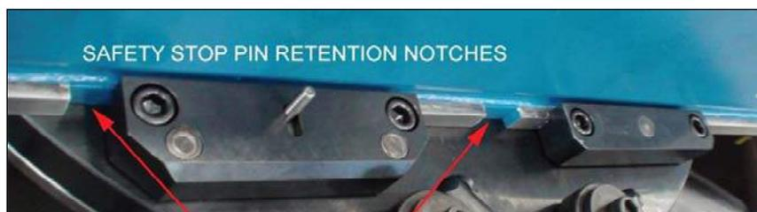
Рис. 3-17. ПАЗЫ ФИКСАЦИИ ПРЕДОХРАНИТЕЛЬНОГО СТОПОРНОГО ШТИФТА
