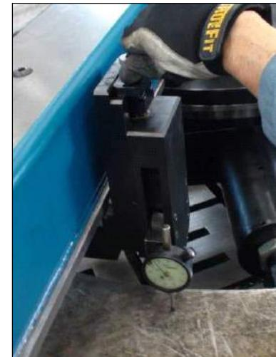
**Рис. 3-28. РАСПОЛОЖЕНИЕ ЦИФЕРБЛАНТНОГО ИНДИКАТОРА**
