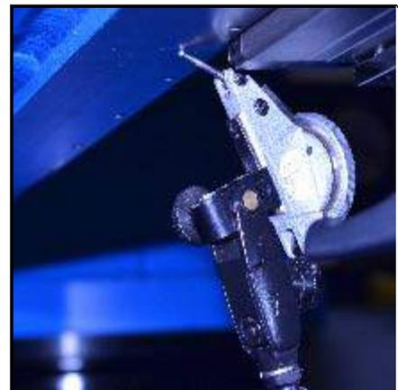
**ABBILDUNG 3-57. KONTAKT ZWISCHEN ANZEIGE UND FRÄSKOPFTRÄGERUNTERSEITE**
