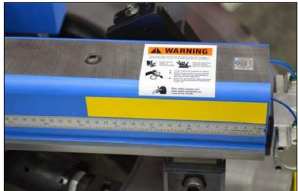
**ABBILDUNG 3-19. FRÄSARM-MESSSKALA**
