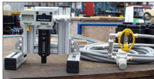
**ABBILDUNG 4-2. KONFIGURATION DER PNEUMATIKEINHEIT (LINKS OPTION 1; RECHTS OPTION 2)**
