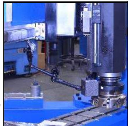
**ABBILDUNG 3-56. MONTIERTE MESSUHR**
