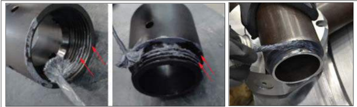
FIGURE 3-26. ENDROITS OÙ APPLIQUER DE L'ANTI-GRIPPANT
