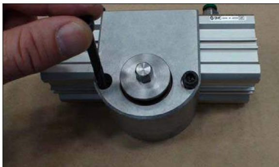
FIGURE 3-31. DÉTAIL DES BOULONS DE L'ARBRE D'AVANCE
