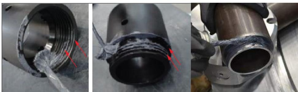
Рисунок 12. Точки нанесения противозадирной смазки
