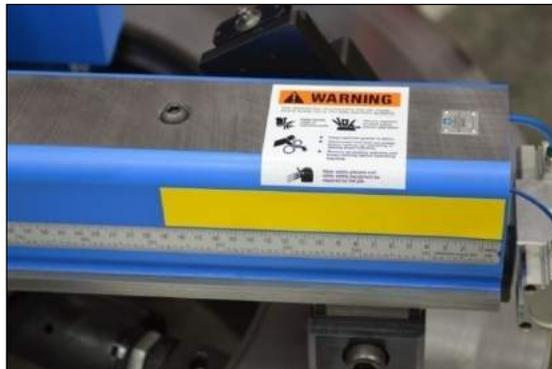
Рисунок 9. Линейка рычага механообработки
