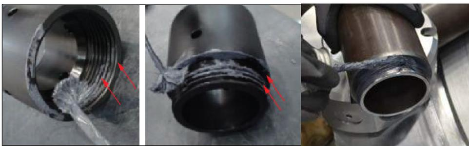
Рисунок 12. Точки нанесения противозадирной смазки
