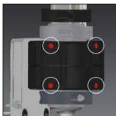
Красными точками указаны точки регулировки для выравнивания шлифовальной насадки на поверхности.
