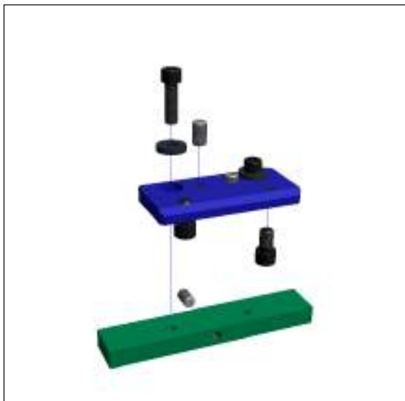
Рисунок 17. Деталировка комплекта для поверхностной установки
