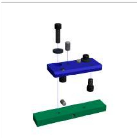
Рисунок 17. Детализовка комплекта для поверхностной установки
