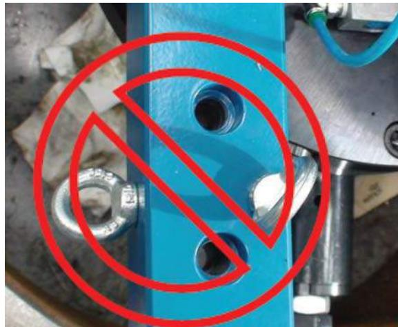
В верхней части поворотного стола находится четыре транспортировочных кольца. В зависимости от направления обработки, закрепите транспортировочные кольца из комплекта поставки в нужных местах. При подъеме станка всегда внимательно следите за центром тяжести. Для предотвращения опасных ситуаций всегда следите за тем, чтобы все детали станка были закреплены должным образом.
