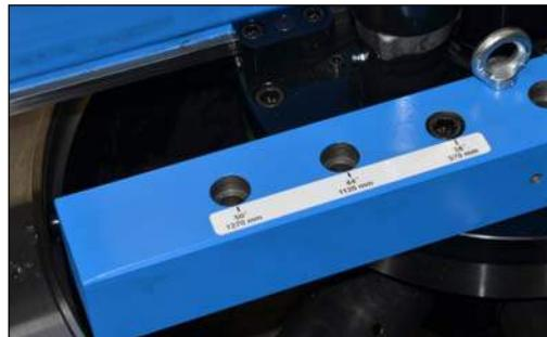
Рисунок 11. Крепления противовесов
