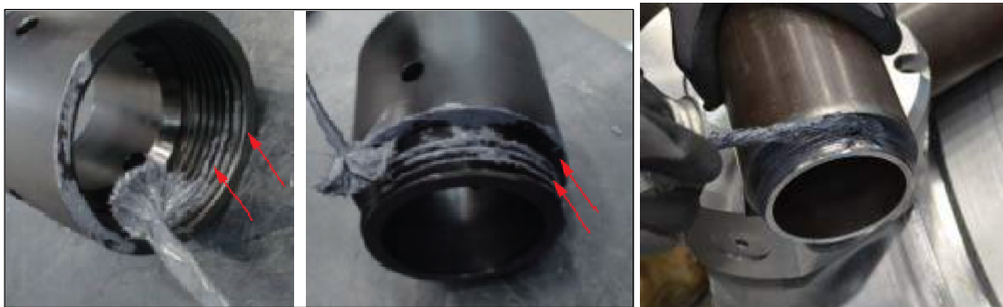
Abbildung 12. Schmiermittel gegen Festbrennen
