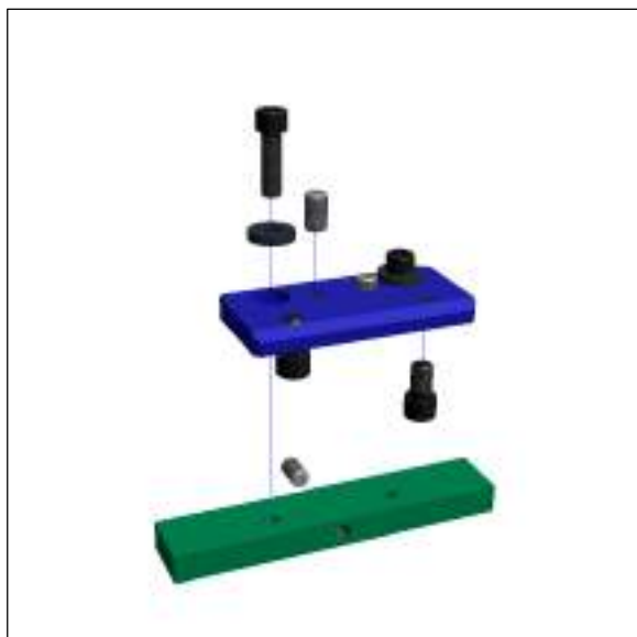
Abbildung 17. Detail des Planflächenmontagesatzes
