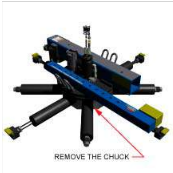
Abbildung 15. Die Einspanner entfernen
