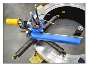
FIGURE 3-4. ADJUST THE TURNING ARM
