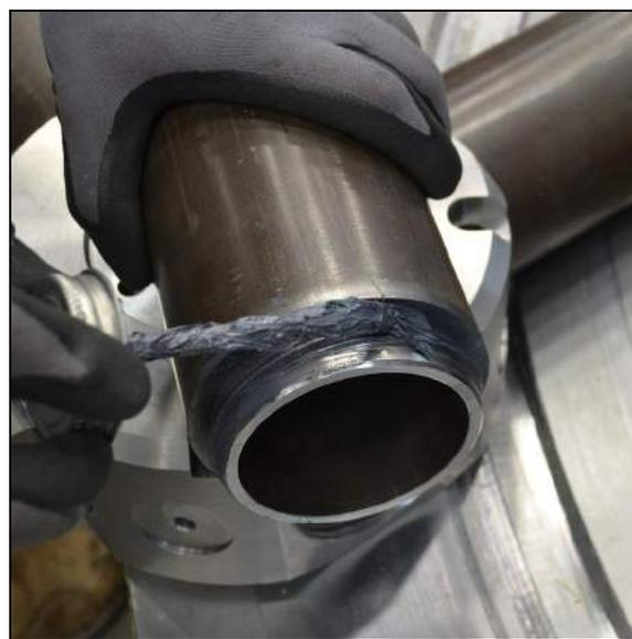
FIGURA 3-12. APLICACIÓN DEL COMPUESTO ANTIADHERENTE
