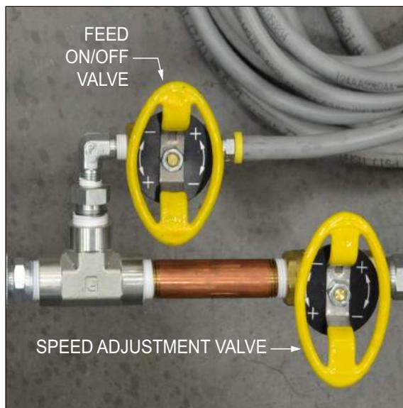
FIGURA 4-2. VÁLVULAS DE MECANIZADO NEUMÁTICAS
