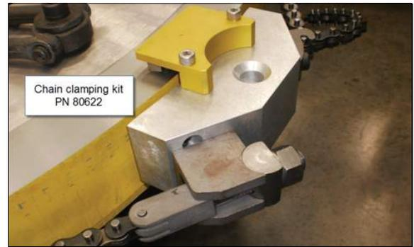
**FIGURA 3-23. ACOPLAMIENTO DEL AMARRE EXTERIOR MEDIANTE EL KIT DE SUJECIÓN POR CADENA CLIMAX**
