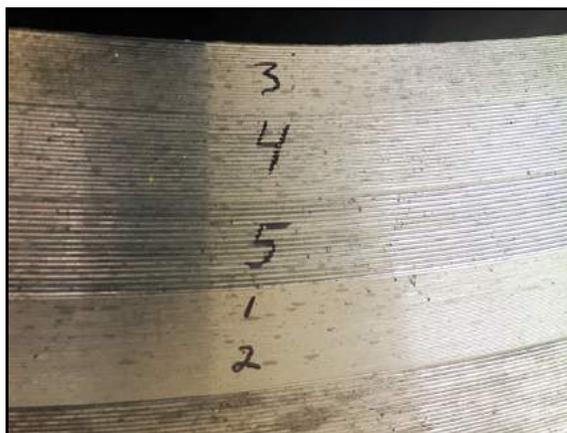
**FIGURE 3-34. ROTACIONES DE LOS MANDOS MARCADOS EN LA BRIDA MECANIZADA**
