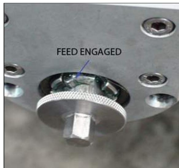
FIGURA 3-33. DETALLE DE LAS POSICIONES DE LA CAJA DE ALIMENTACIÓN
