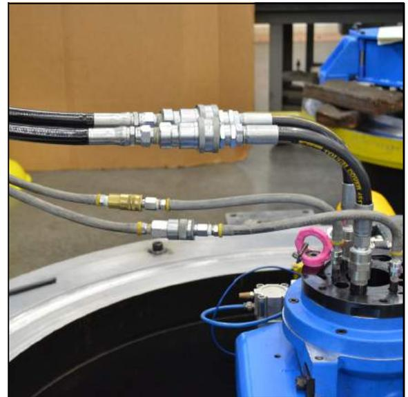
FIGURA 3-8. CONEXIÓN DE LAS MANGUERAS (VERSIÓN HIDRÁULICA)
