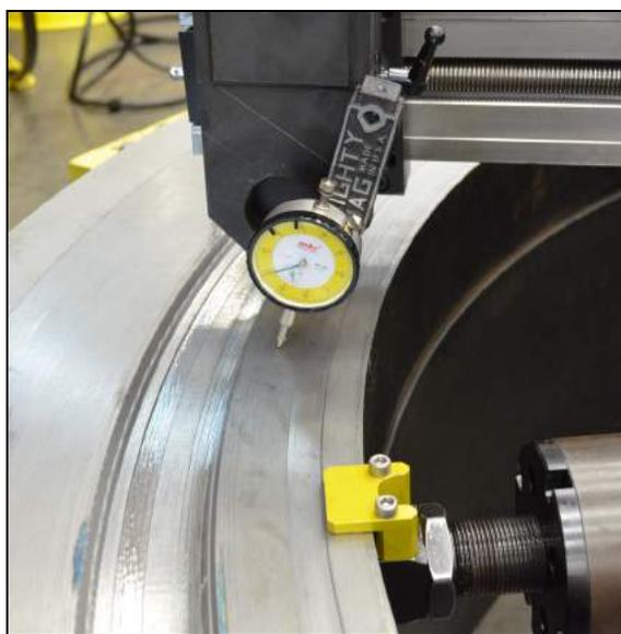
**FIGURA 3-6. NIVELACIÓN Y CENTRADO DEL PORTAÚTILES INTERIOR**
