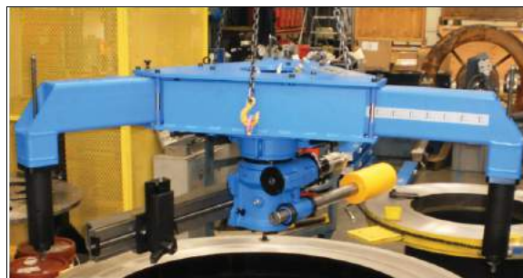
РИСУНОК 3-19. УЗЕЛ КРЕПЛЕНИЯ НА НАРУЖНОМ ДИАМЕТРЕ В СБОРЕ
