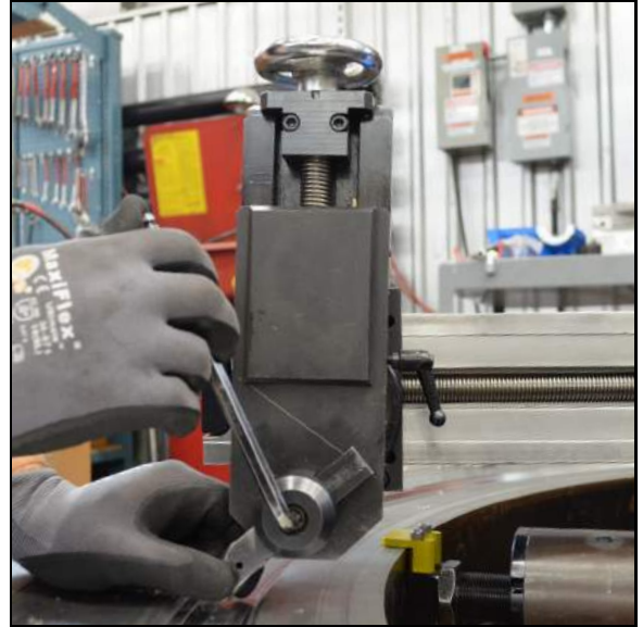
РИСУНОК 3-7. УСТАНОВКА ВСТАВНОГО РЕЗЦА
