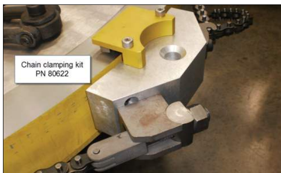
РИСУНОК 3-23. ПРИСОЕДИНЕНИЕ УЗЛА КРЕПЛЕНИЯ НА НАРУЖНОМ ДИАМЕТРЕ С ПОМОЩЬЮ КОМПЛЕКТА ЗАЖИМОВ ЦЕПИ CLIMAX
