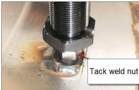
РИСУНОК 3-22. ПРИСОЕДИНЕНИЕ УЗЛА КРЕПЛЕНИЯ НА НАРУЖНОМ ДИАМЕТРЕ С ПОМОЩЬЮ ПРИХВАЧЕННОЙ СВАРКОЙ ГАЙКИ
