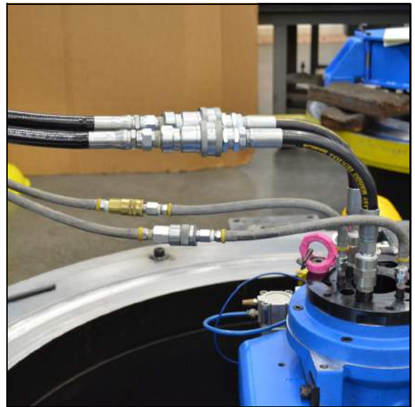
РИСУНОК 3-8. ПОДСОЕДИНЕНИЕ ШЛАНГОВ (ГИДРАВЛИЧЕСКАЯ ВЕРСИЯ)
