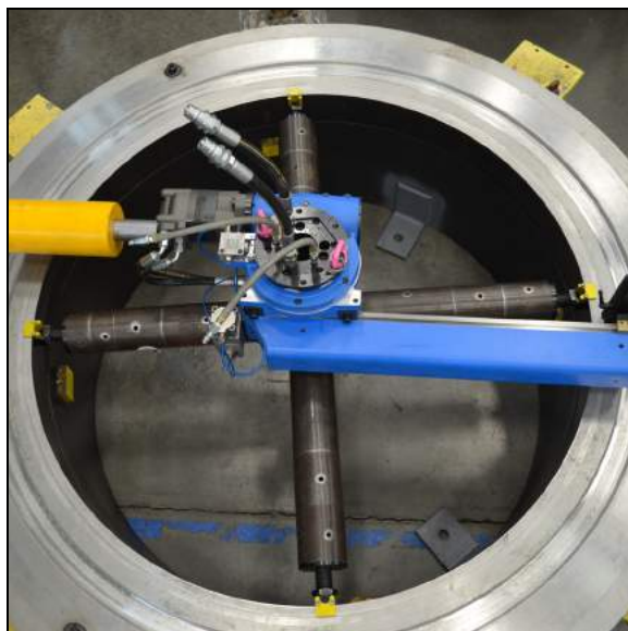
РИСУНОК 3-5. УСТАНОВКА ПАТРОНА ДЛЯ ЗАЖИМА НА ВНУТРЕННЕМ ДИАМЕТРЕ НА ФЛАНЦЕ
