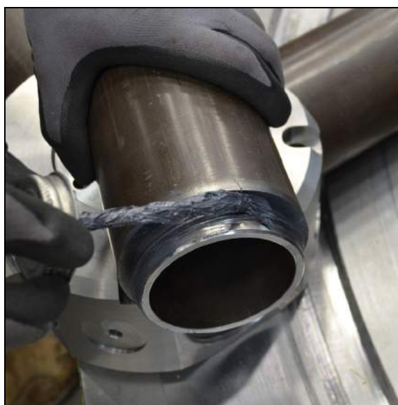
Рисунок 3-12. Нанесение противозадирного состава
