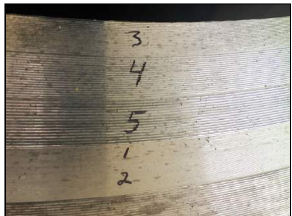
FIGURE 3-34. TOURS DE BOUTON MARQUÉS SUR LA BRIDE USINÉE
