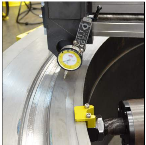
FIGURE 3-6. NIVELLEMENT ET CENTRAGE DU MANDRIN DI
