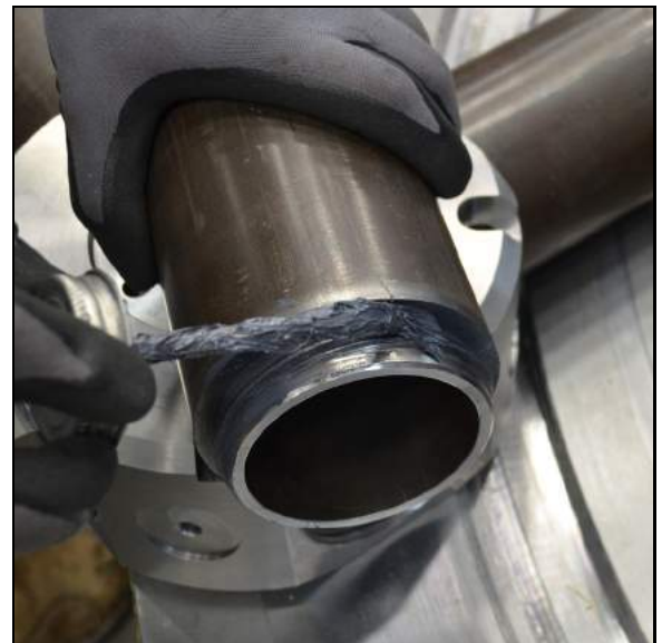
FIGURE 3-12. APPLICATION D'UN ANTI-GRIPPANT
