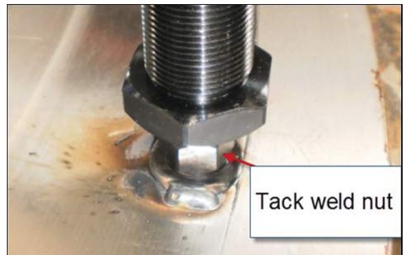
FIGURE 3-22. FIXATION DU MONTAGE DE À L'AIDE D'UN ÉCROU À SOUDER PAR POINTS
