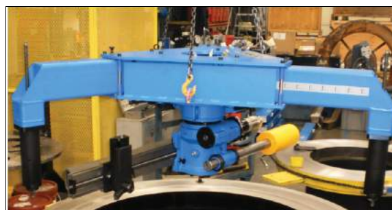
FIGURE 3-19. MONTAGE EN DIAMÈTRE EXTERNE (DE)
