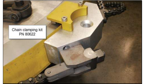
FIGURE 3-23. FIXATION DU MONTAGE DE À L'AIDE D'UN KIT DE CHAÎNE DE FIXATION CLIMAX
