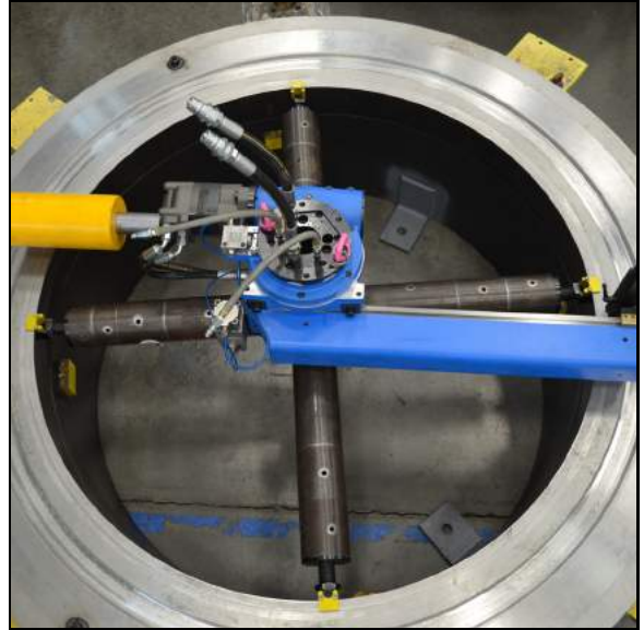
FIGURE 3-5. MISE EN PLACE DU MANDRIN DI DANS LA BRIDE
