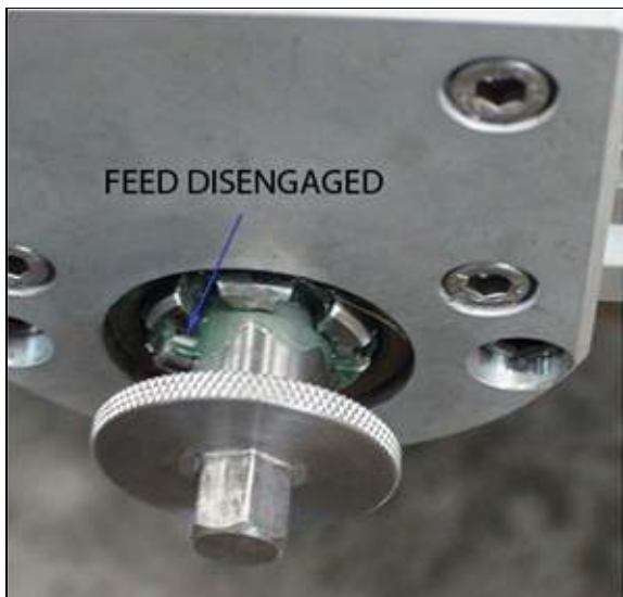
FIGURE 3-33. DÉTAILS DES POSITIONS DU MODULE D'AVANCE
