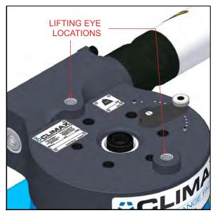
FIGURE 3-1. 59626 M12 LIFTING EYES
