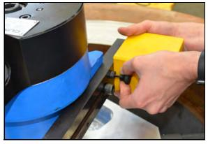
FIGURE 3-11. DETENT PLUNGER IN COUNTERWEIGHT ARM
