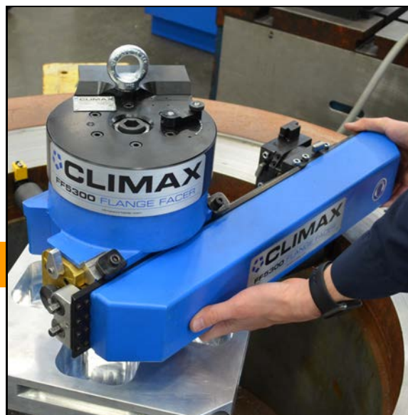
FIGURA 3-10. COLOCACIÓN DEL BRAZO DE MECANIZADO EN SU SITIO
