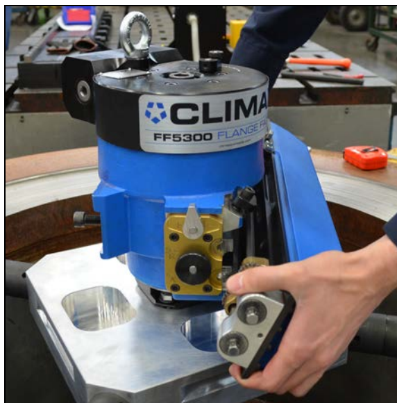
FIGURA 3-9. INSTALACIÓN DEL BRAZO DE MECANIZADO
