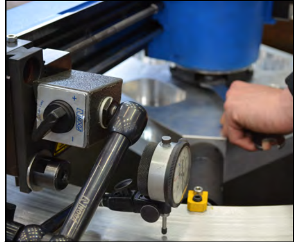
РИСУНОК 3-17. УСТАНОВЛЕННЫЙ ЦИФЕРБЛАТНЫЙ ИНДИКАТОР
