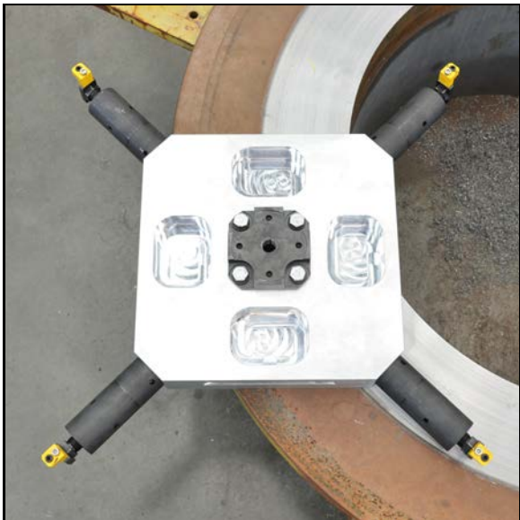
ABBILDUNG 3-4. ZUSAMMENGEBAUTE INNENSPANNVORRICHTUNG (HIER GEZEIGT: GROßE SPANNVORRICHTUNG)
