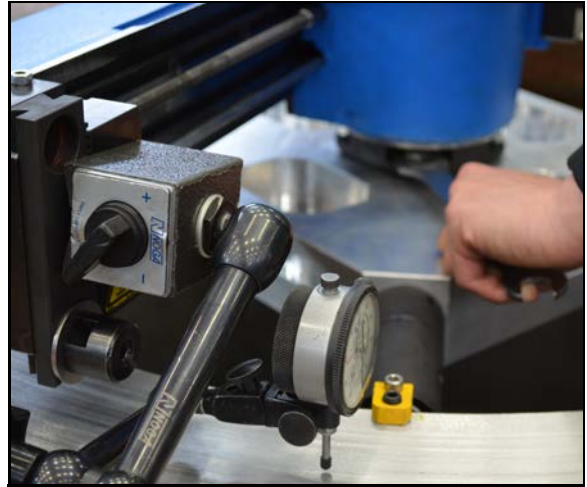
FIGURE 3-17. INDICATEUR À CADRAN EN PLACE
