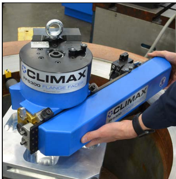
FIGURE 3-10. MISE EN PLACE DU BRAS D'USINAGE
