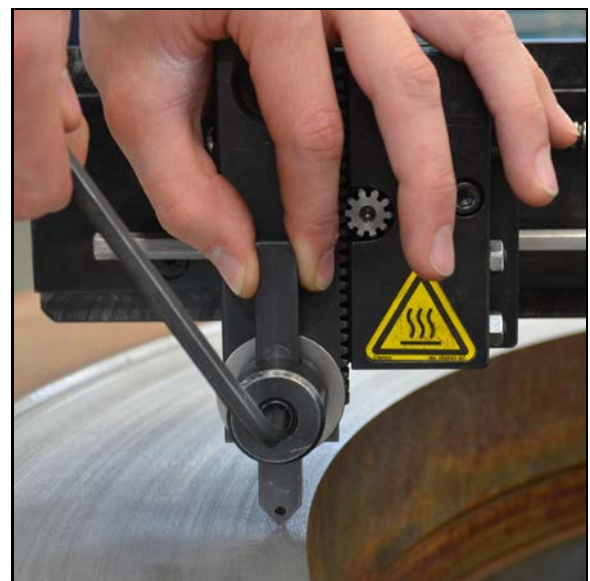
FIGURE 3-20. INSTALLATION DE L'OUTIL DE COUPE
