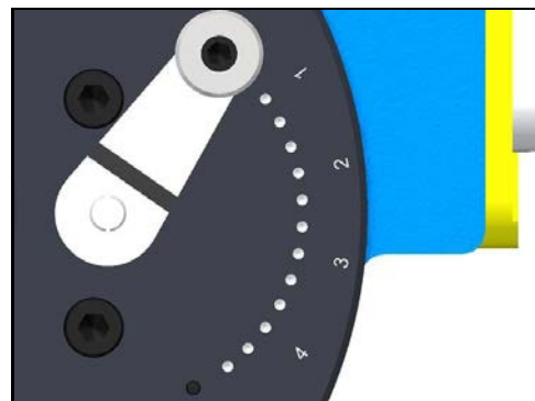
FIGURE 2-7. POSITION DE LA VITESSE D'AVANCE
