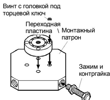
**Рис. 3 – Монтажная переходная пластина**
