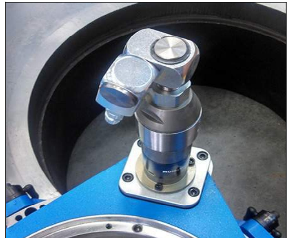
FIGURA 3-25. MOTOR INSTALADO (SE MUESTRA EN FF1200)
