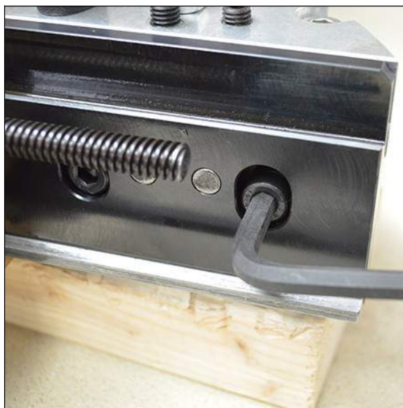
FIGURA 3-36. AFLOJE LOS TORNILLOS DESLIZANTES RADIALES (SE MUESTRA EN FF1200)
