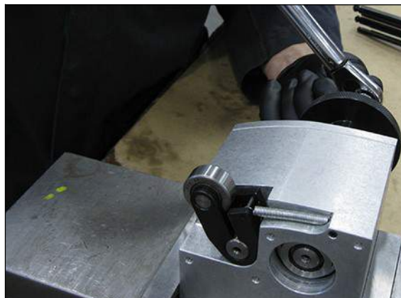
FIGURA 5-4. AJUSTE DEL TORNILLO DEL BRAZO DE LA LEVA PARA CORREGIR EL VALOR DE TORQUE
