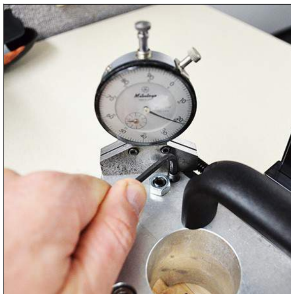
FIGURA 3-37. AJUSTE LA INCLINACIÓN DEL DESLIZAMIENTO RADIAL (SE MUESTRA EN FF1200)
