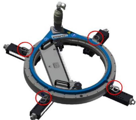
FIGURA 3-2. PUNTOS DE ELEVACIÓN EN RDU PARA FF2400 Y FF3600 (SE MUESTRA FF2400)
