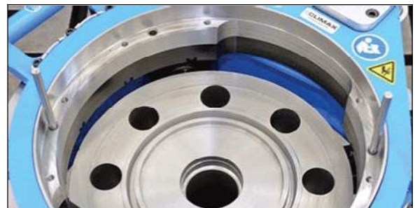
FIGURA 3-18. VARILLAS DE 5/16" (7,93 mm) PARA GIRAR MANUALMENTE LA RDU (SE MUESTRA ENFF1200)
