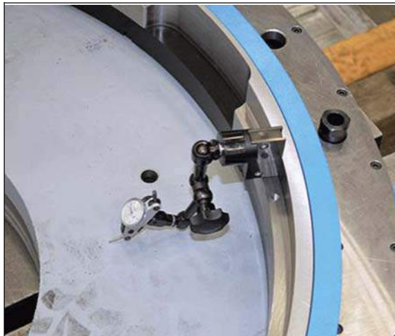
Рис. 3-19. ЦЕНТРИРОВАНИЕ УЗЛА ПОВОРОТНОГО ПРИВОДА (ПОКАЗАНА МОДЕЛЬ FF3600)
