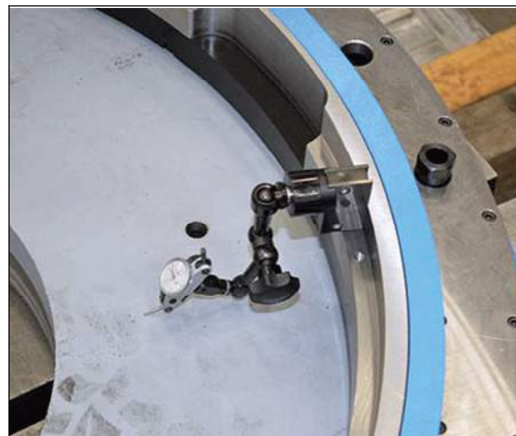
ABBILDUNG 3-17. NIVELLIEREN DES DREHANTRIEBS (FF3600 DARGESTELLT)
