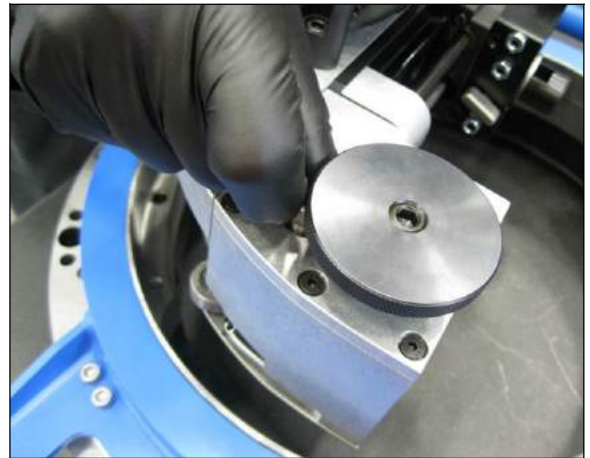
ABBILDUNG 3-20. SCHLITTENGÄHUSE ÜBER DEM NOCKENSCHLITZ AUSRICHTEN (FF1200 DARGESTELLT)
