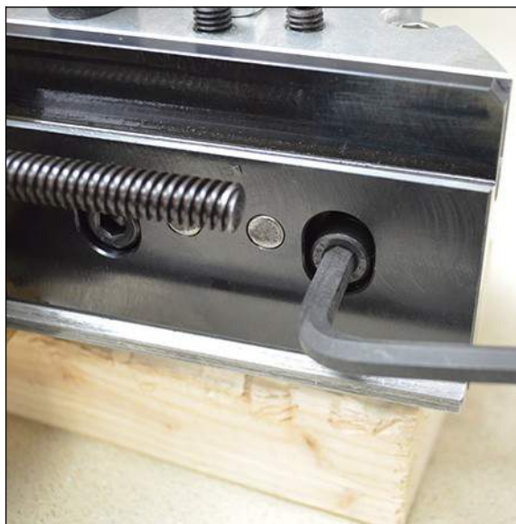
ABBILDUNG 3-36. DSCHRAUBEN DES RADIALEN SCHLITTENS LÖSEN (FF1200 DARGESTELLT)
