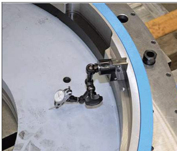
ABBILDUNG 3-19. ZENTRIEREN DES DREHANTRIEBS (FF3600 DARGESTELLT)
