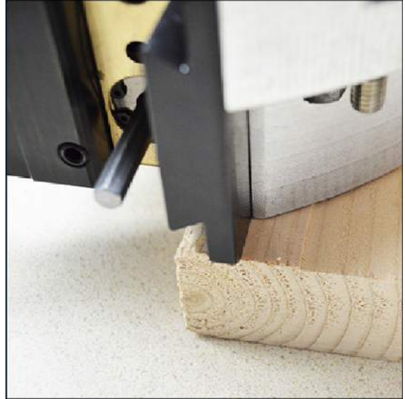
ABBILDUNG 3-32. DEN RADIALSCHLITTEN ABSTÜTZEN (FF1200 DARGESTELLT)
