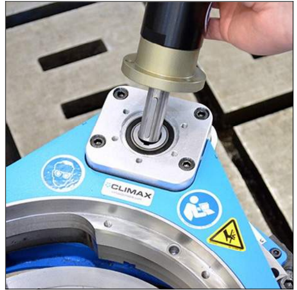
ABBILDUNG 3-24. PNEUMATIKANTRIEB AUSRICHTEN (FF1200 DARGESTELLT)
