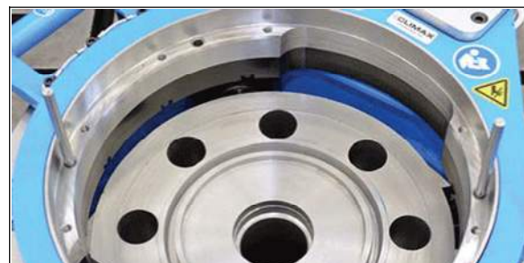
ABBILDUNG 3-18. 5/16" (7,93 mm) STANGEN ZUM MANUELLEN DREHEN DES DREHANTRIEB-LAGERS (FF1200 DARGESTELLT)
