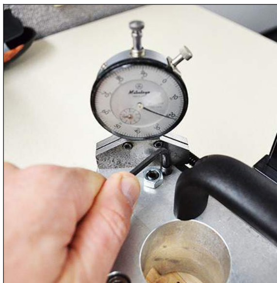
ABBILDUNG 3-37. RADIALSCHLITTENNEIGUNG EINSTELLEN (FF1200 DARGESTELLT)
