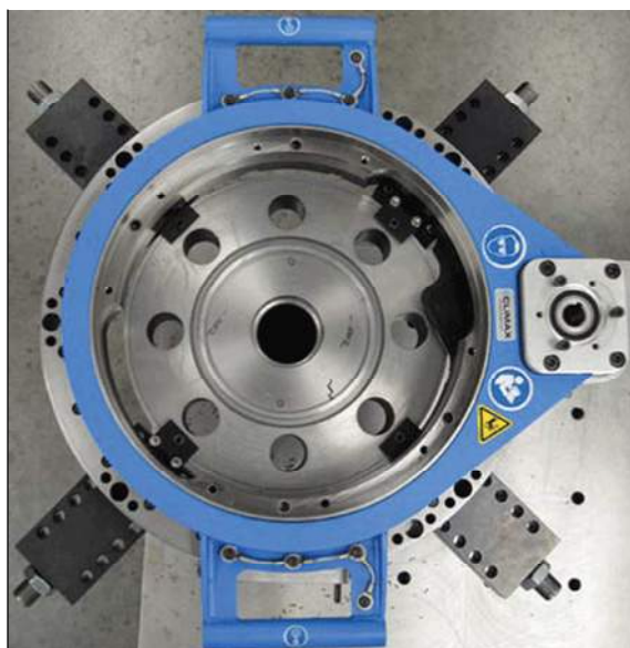
ABBILDUNG 3-10. BEFESTIGUNG DER MASCHINE AUF DEM WERKSTÜCK (FF1200 DARGESTELLT)
