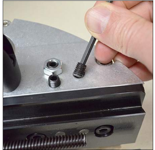
ABBILDUNG 3-34. STOPFENSCHRAUBE ENTFERNEN (FF1200 DARGESTELLT)
