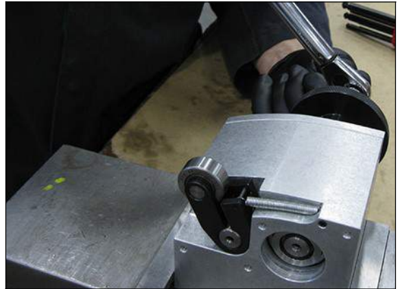
ABBILDUNG 5-4. NOCKENARMSCHRAUBE AUF DEN RICHTIGEN DREHMOMENT EINSTELLEN
