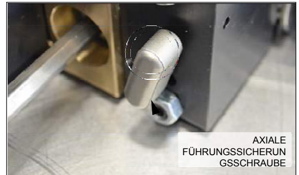
ABBILDUNG 4-3. SICHERUNGSSCHRAUBE AXIALFÜHRUNG (FF1200 DARGESTELLT)
