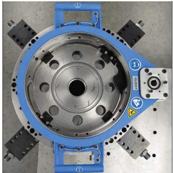
FIGURE 3-10. MONTER LA MACHINE SUR LA PIÈCE À USINER (FF1200 ILLUSTRÉE)
