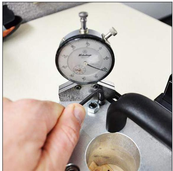
**FIGURE 3-37. RÉGLER L'INCLINAISON DE LA GLISSIÈRE RADIALE (FF1200 ILLUSTRÉE)**
