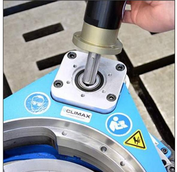
FIGURE 3-24. ALIGNER LE MOTEUR PNEUMATIQUE (FF1200 ILLUSTRÉE)
