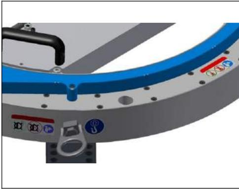
**FIGURE 1-5. EMBLEMES DES ÉTIQUETTES SUR LES CÔTÉS DE L'UNITÉ D'ENTRAÎNEMENT ROTATIF (RDU)**
