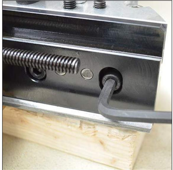
**FIGURE 3-36. DESSERRER LES VIS DE LA GLISSIÈRE RADIALE (FF1200 ILLUSTRÉE)**
