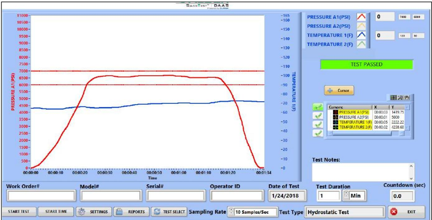
FIGURA 4-4. EJEMPLO DE PRUEBA HIDROSTÁTICA APROBADA
