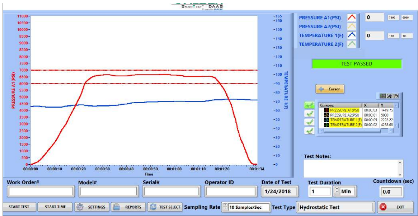
ABBILDUNG 4-4. BEISPIEL FÜR DEN POSITIVEN VERLAUF EINES HYDROSTATISCHEN TESTS
