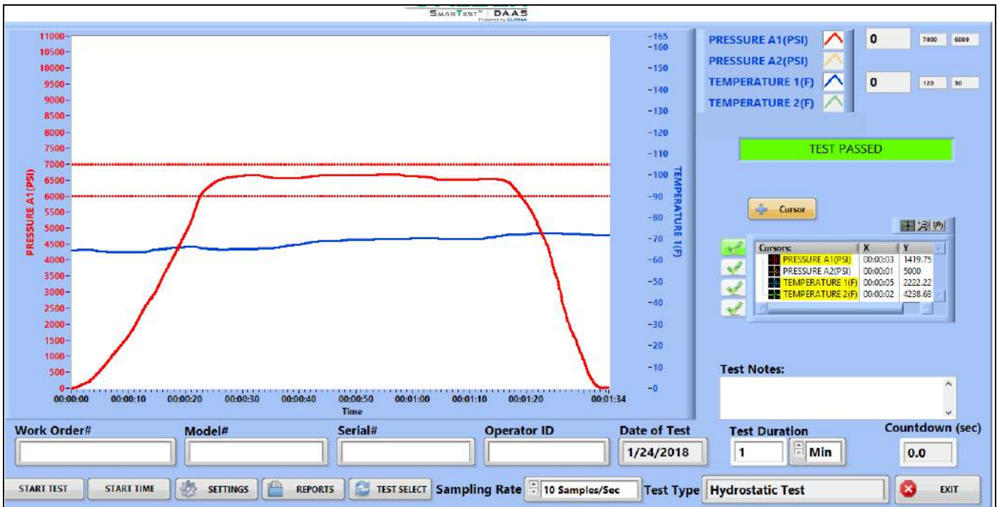
FIGURE 4-4. EXEMPLE DE TEST HYDROSTATIQUE RÉUSSI
