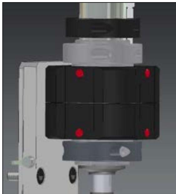
ABBILDUNG 4-31. SCHLEIFKOPF-NIVELLIERSCRAUBEN
