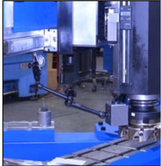
ABBILDUNG 4-2. MESSUHR AM PLANFRÄSER
