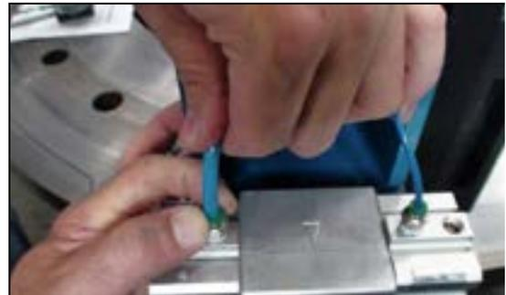
ABBILDUNG 4-47. VERFAHREN ZUM TRENNEN DER FÖRDESCHLÄUCHE
