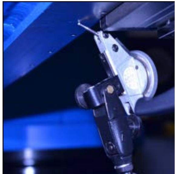
ABBILDUNG 4-3. ANZEIGER BERÜHRT MASCHINENSTÖßEL-
