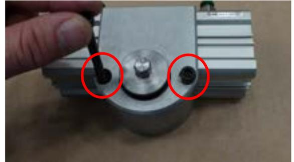
ABBILDUNG 4-44. ENTFERNEN DER SCHRAUBEN IN GEGENLAUFRICHTUNG
