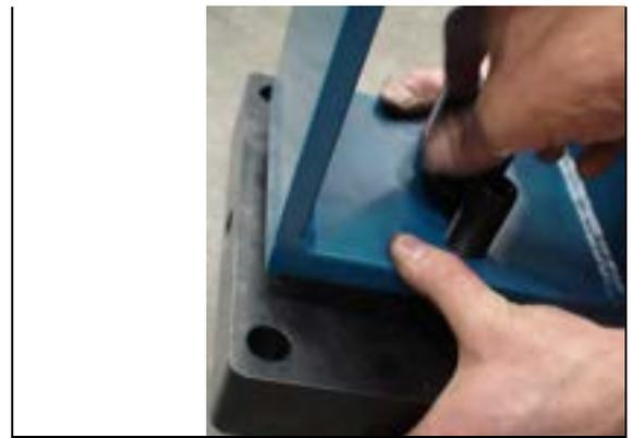
ABBILDUNG 3-17. ZENTRIERPLATTE FÜR AUßENMONTAGE
