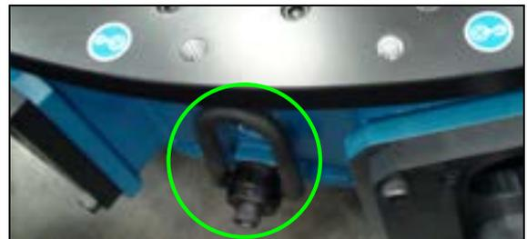
ABBILDUNG 3-3. HEBERINGE ZUM ANHEBEN DER MONTIERTEN MASCHINE IN VERTIKALER POSITION
