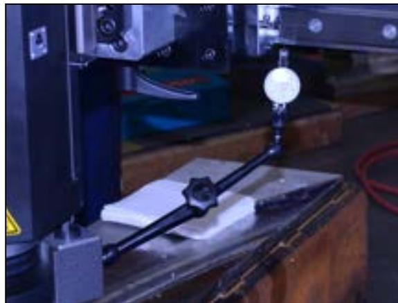
ABBILDUNG 4-4. SPINDEL ZUR STÖßELOBERFLÄCHE GEDREHT
