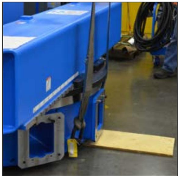
ABBILDUNG 3-28. SPERRHOLZ UND RIEMEN FÜR DIE INVERSION
