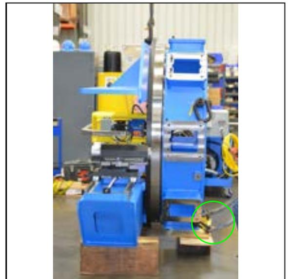
ABBILDUNG 3-30. VERTIKALE CM6200 AUF BLÖCKEN MIT WIEDER ANGEBRACHTEN GURTEN
