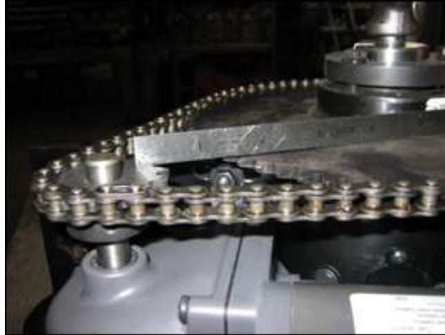
Abbildung 17 Einstellung der Antriebskette
