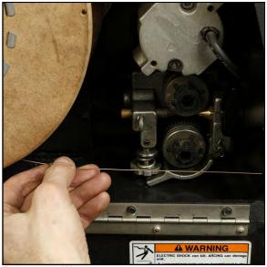
FIGURE 3-28. WIRE STRAIGHTENED BEFORE FEEDING
