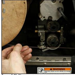
FIGURE 3-28. WIRE STRAIGHTENED BEFORE FEEDING
