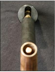
FIGURE 3-8. TORCH ALIGNED WITH THE TRAVEL SLOT
