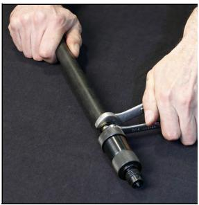
FIGURE 3-9. JAM NUT TIGHTENED
