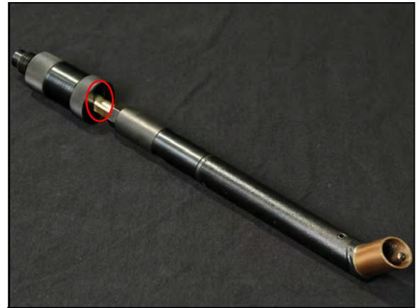
FIGURA 3-32. ORIENTACIÓN DE LA BOQUILLA DEL SOPLETE
