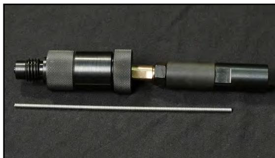
FIGURA 3-30. LINER Y ADAPTADOR DE SOPLETE ESTÁNDAR
