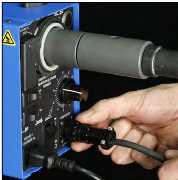
**FIGURA 3-25. CABLE DE CONTROL DE ALIMENTACIÓN DE ALAMBRE CONECTADO**
