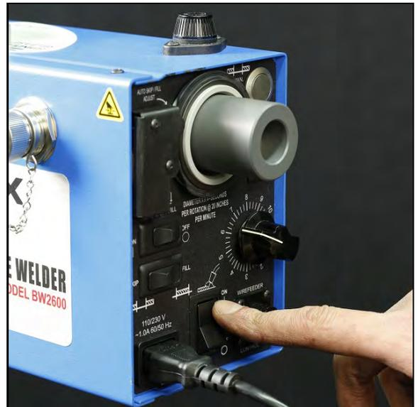
FIGURA 3-29. INTERRUPTOR DE INICIO DE SOLDADURA
