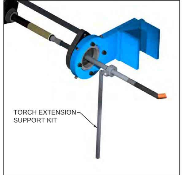
FIGURA 3-34. KIT DE SOPORTE DE LA EXTENSIÓN DEL SOPLETE
