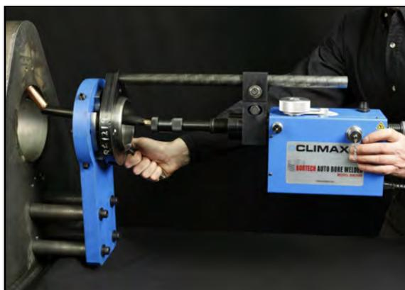
FIGURA 3-16. SUJECIÓN DE LA MÁQUINA DE SOLDADURA DE PERFORACIÓN PARA EL AJUSTE DE PANDEO (LAS EXTENSIONES NO APARECEN)
