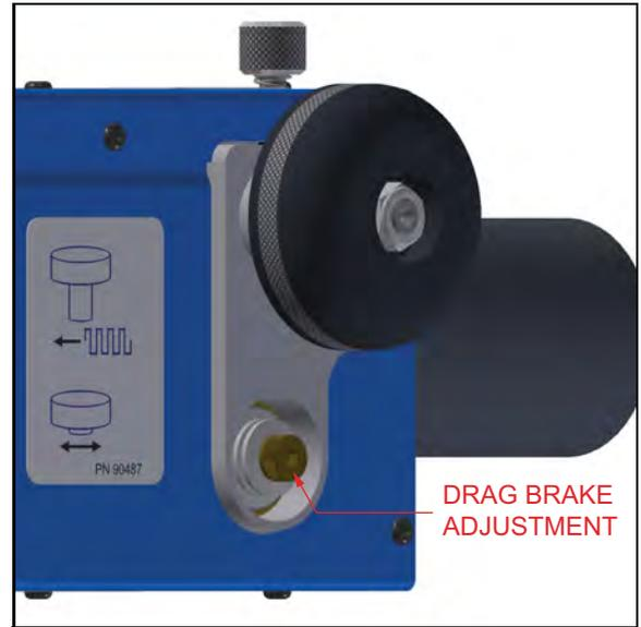
FIGURA 2-4. AJUSTE DEL FRENO DE ARRASTRE
