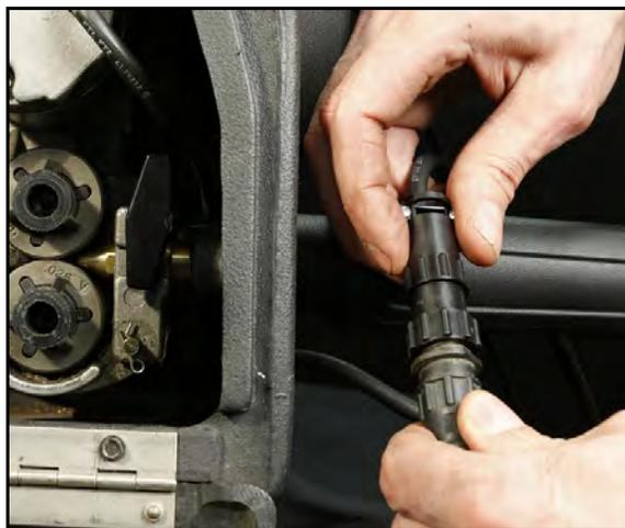
**FIGURA 3-27. CABLE DE CONTROL DE ALIMENTACIÓN DE ALAMBRE CONECTADO AL ALIMENTADOR DE ALAMBRE**
