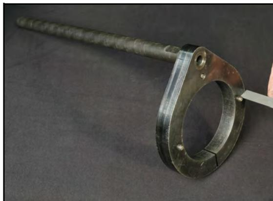
**FIGURA 3-2. FIJE LOS TORNILLOS EN LA PLACA ADAPTADORA**
