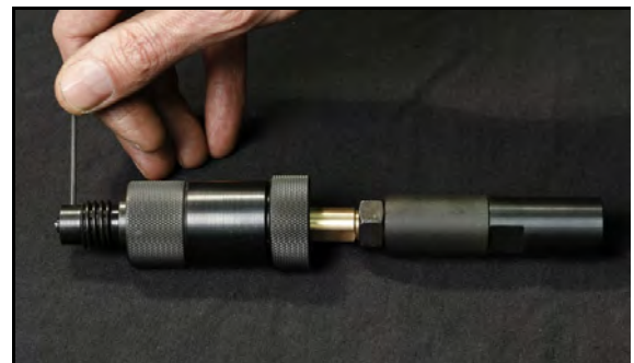
ABBILDUNG 3-31. AUSKLEIDUNG IM SCHWENKKOPF ANGEZOGEN
