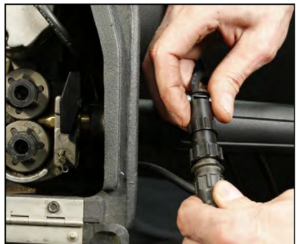
ABBILDUNG 3-27. DRAHTVORSCHUBSTEUERKABEL AN DRAHTVORSCHUBGERÄT ANGESCHLOSSEN
