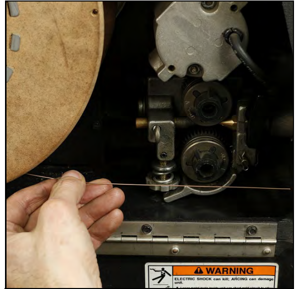
ABBILDUNG 3-28. DRAHT VOR DEM ZUFÜHREN GERADE GERICHTET
