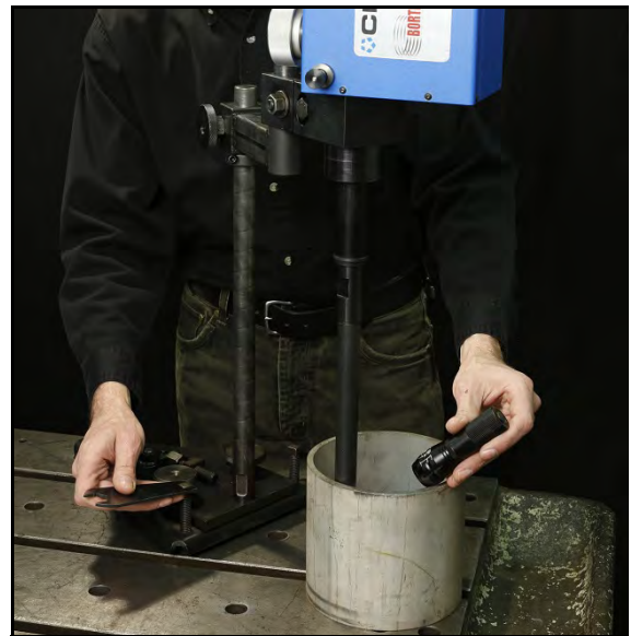
ABBILDUNG 3-20. PARALLELITÄTSKONTROLLE BEI 3 UHR
