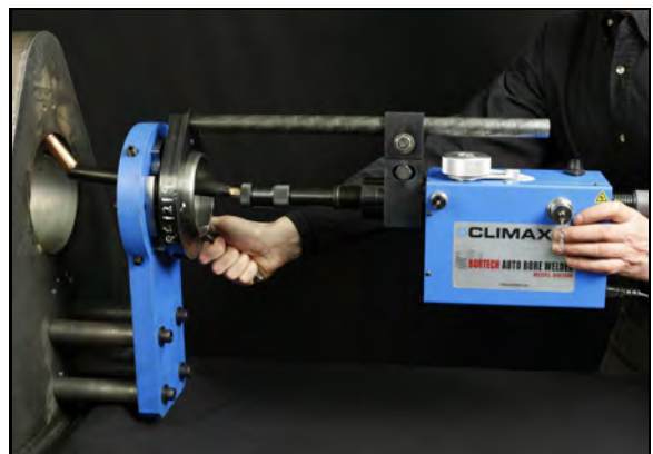
ABBILDUNG 3-16. ABSTÜTZEN DES BOREWELDERS ZUR ANPASSUNG AN DEN DURCHHANG (VERLÄNGERUNGEN NICHT GEZEIGT)
