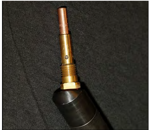
ABBILDUNG 3-10. AUSKLEIDUNG DURCH DIE GASLÖCHER DES ABLENKERS
