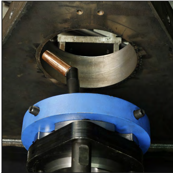
ABBILDUNG 3-15. SCHWENKEN DES BOREWELDERS ZUR ZENTRIERUNG
