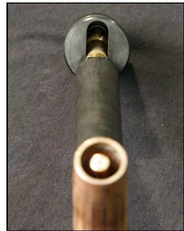
ABBILDUNG 3-8. AUF DEN HUBSCHLITZ AUSGERICHTETER BRENNER
