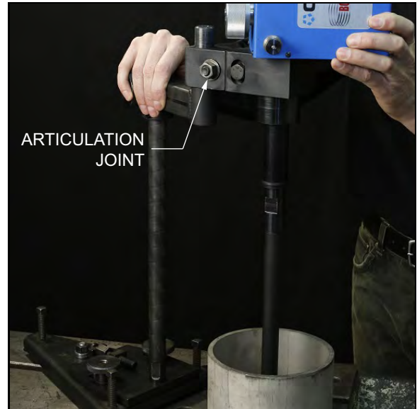
ABBILDUNG 3-22. BW2600 ARTIKULIERT IN DER MITTE DER BOHRUNG (GELENKVERBINDUNG ABGEBILDET)
