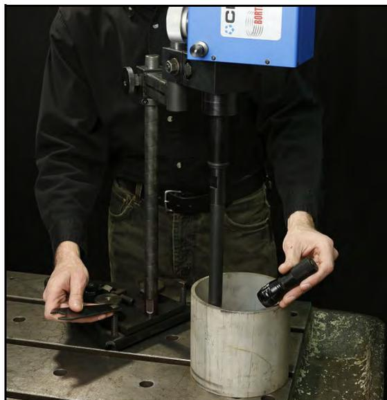
FIGURE 3-20. CONTRÔLE DU PARALLÉLISME À 3 HEURES
