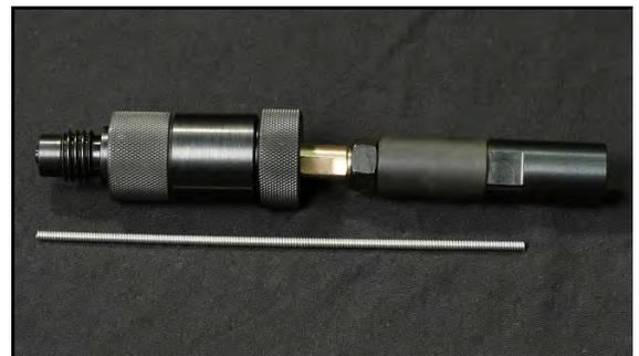
FIGURE 3-30. GAINE ET ADAPTATEUR DE TORCHE STANDARD
