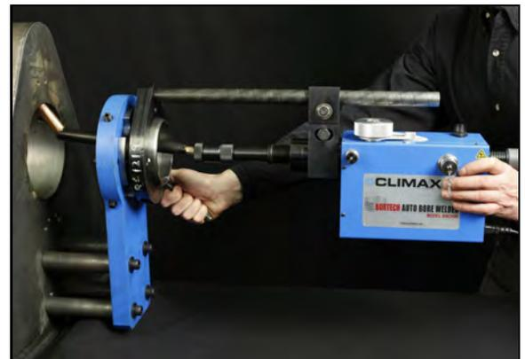
FIGURE 3-16. SOUTIEN DE LA SOUDEUSE POUR RECHARGEMENT D'ALÉSAGE POUR LE RÉGLAGE DE LA FLÈCHE (RALLONGES NON REPRÉSENTÉES)
