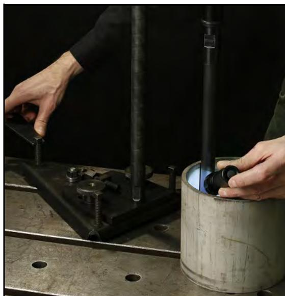
FIGURE 3-21. CONTRÔLE DU PARALLÉLISME À 6 HEURES
