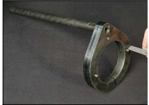
FIGURE 3-2. VIS DE RÉGLAGE DANS LA PLAQUE D'ADAPTATION
