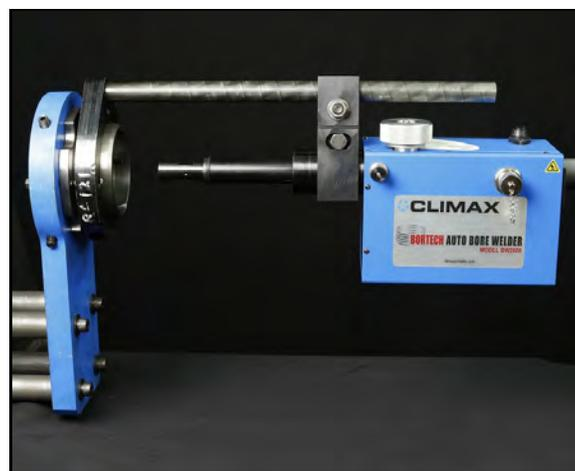
FIGURE 3-6. BW2600 ET DU SUPPORT RADIAL SUR LA TIGE DE MONTAGE
