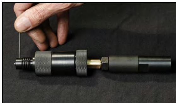
FIGURE 3-31. GAINE SERRÉE DANS LE RACCORD TOURNANT
