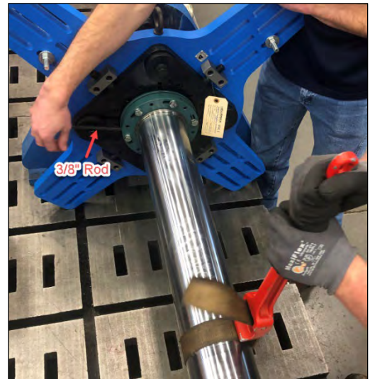
Abbildung 14. Einsetzen der 3/8"-Stange
