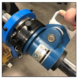
FIGURE 3-9. POSITIONING THE RDU
