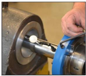
FIGURE 3-6. ALIGNING THE BAR
