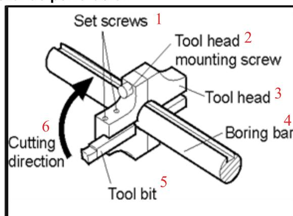
FIGURA 3-8. CONFIGURACIÓN DEL CABEZAL PORTAHERRAMIENTAS
