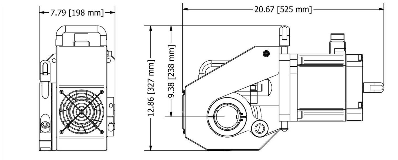
FIGURA 2-9. DIMENSIONES MÁQUINA SERVOACCIONADA BB5000
