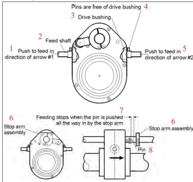
FIGURA 4-1. DESCONECTAR LA ALIMENTACIÓN AXIAL
