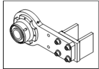
FIGURA 2-6. MONTAJE RODAMIENTO ESFÉRICO DE UN ÚNICO BRAZO
