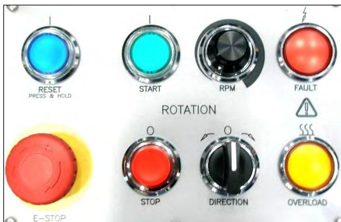
FIGURA 3-16. CONTROLES DEL COLGANTE DEL SERVOMOTOR
