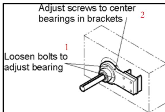
FIGURA 3-5. POSICIONAR LOS RODAMIENTOS ESFÉRICOS
