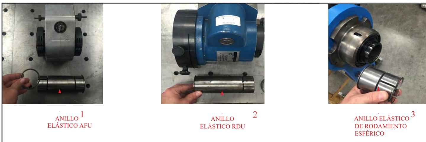
FIGURA 3-20. RETIRADA DE ANILLO ELÁSTICO
