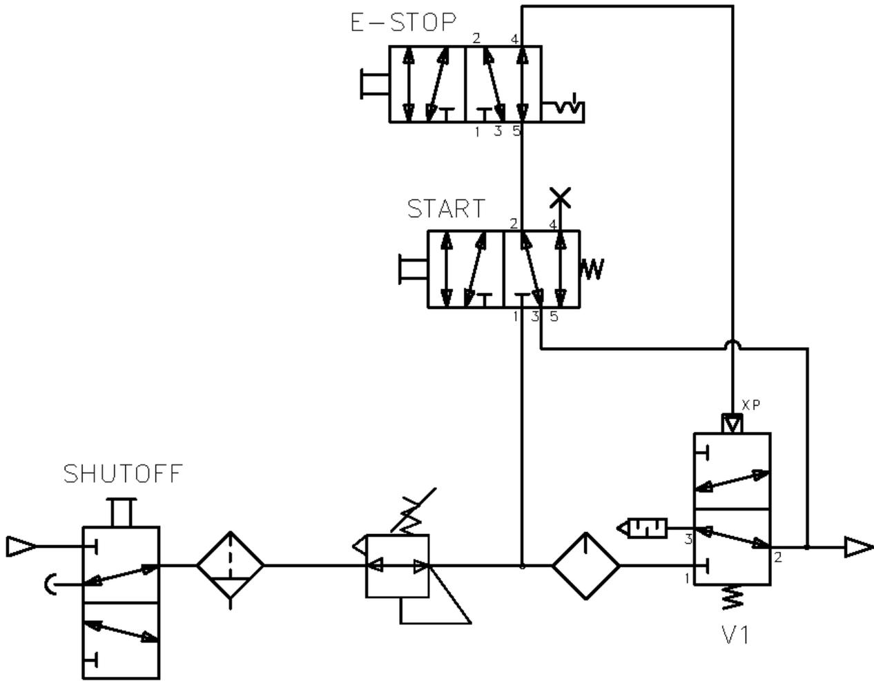
FIGURA C-13. ESQUEMA DE UNIDAD DE ACCIONAMIENTO NEUMÁTICO (N/P 59248)
