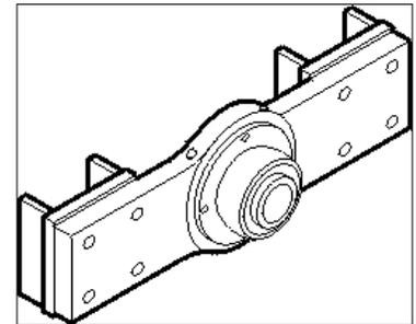
FIGURA 2-7. MONTAJE RODAMIENTO ESFÉRICO DE UN ÚNICO BRAZO
