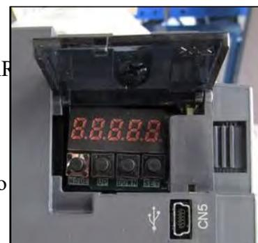
**FIGURA D-1. BOTONES DE FUNCIÓN DEL SERVO-AMPLIFICADOR**
