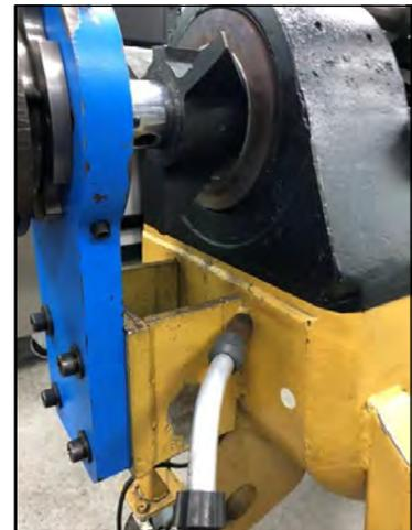
**FIGURA 3-4. CENTRAR LOS RODAMIENTOS ESFÉRICOS**
