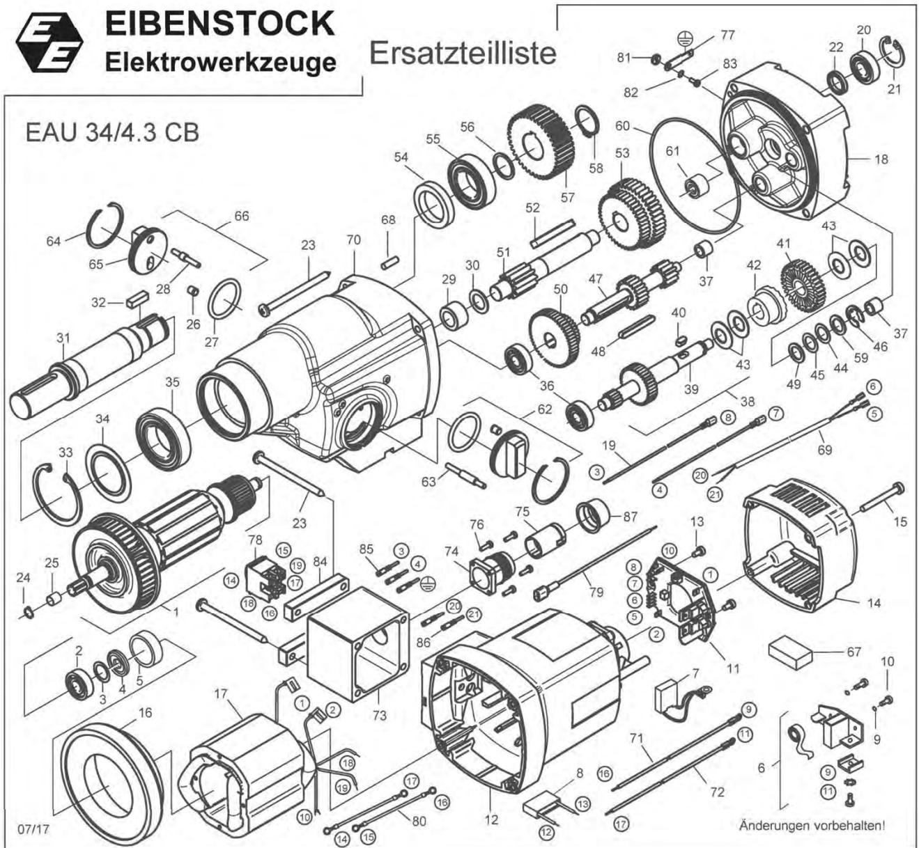
FIGURA A-14. CONJUNTO DE MOTOR EIBENSTOCK -- ÚNICAMENTE SEGUNDA GENERACIÓN
