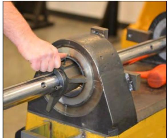
**FIGURA 3-2. INSERCIÓN BARRA PERFORADORA**
