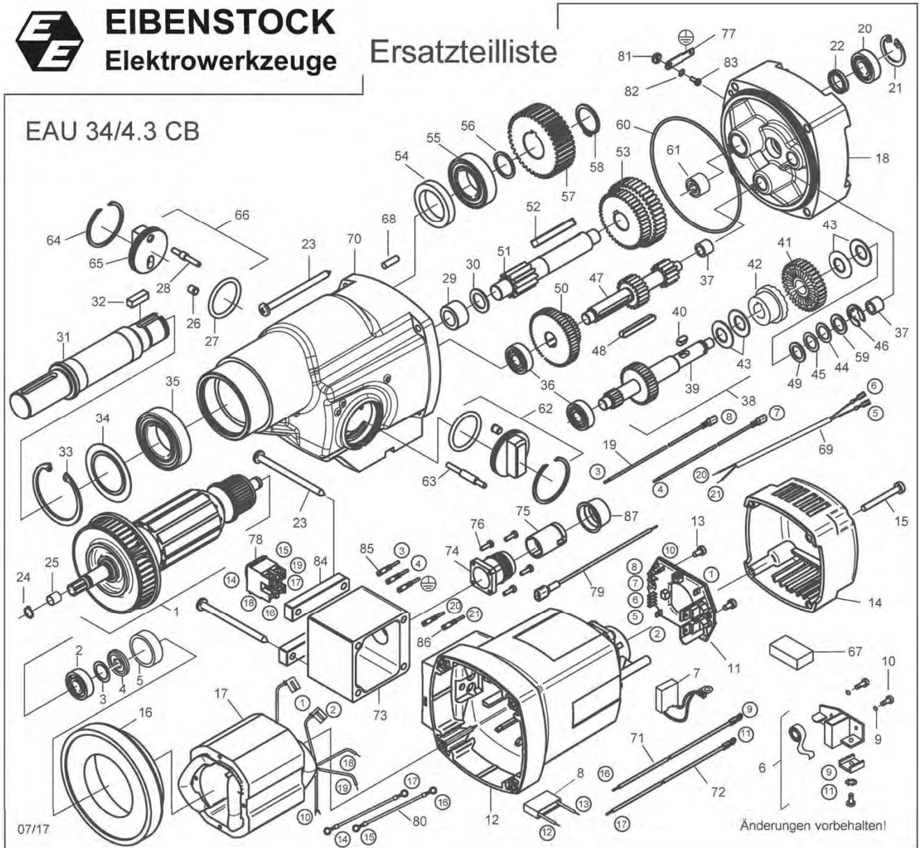
FIGURA B-28. CONJUNTO DE MOTOR EIBENSTOCK -- ÚNICAMENTE SEGUNDA GENERACIÓN
