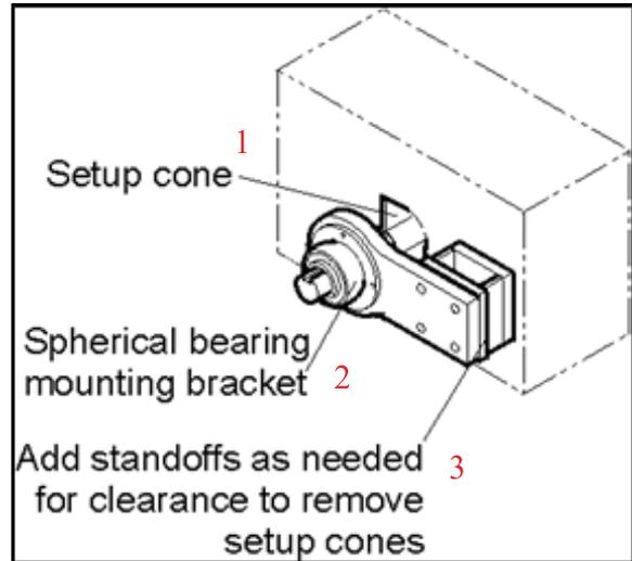
**FIGURA 3-3. INSTALACIÓN DE CONO DE CONFIGURACIÓN**
