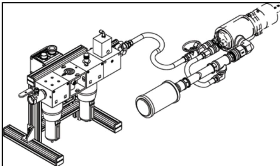
FIGURA 2-12. UNIDAD DE ACONDICIONAMIENTO NEUMÁTICO (PCU)
