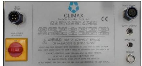
FIGURA 3-15. PANEL DE CONTROL PRINCIPAL SERVOMOTOR
