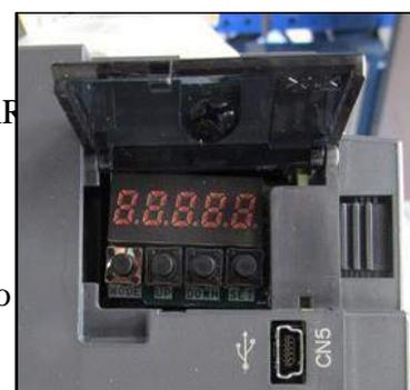
**FIGURA D-1. BOTONES DE FUNCIÓN DEL SERVO-AMPLIFICADOR**
