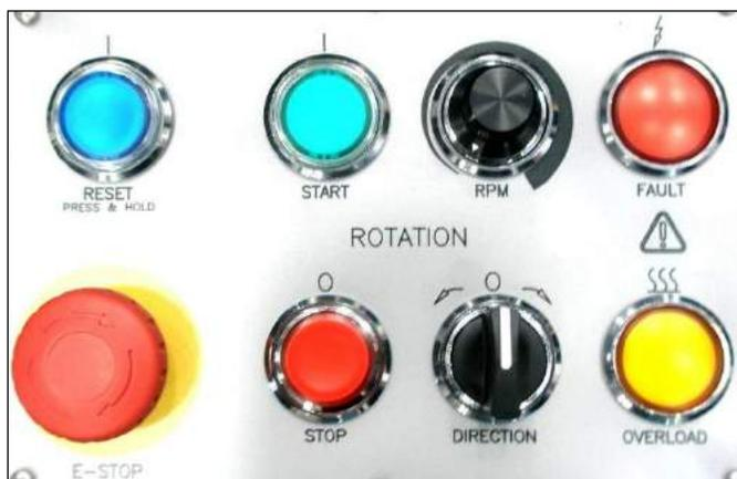
FIGURA 3-16. CONTROLES DEL COLGANTE DEL SERVOMOTOR
