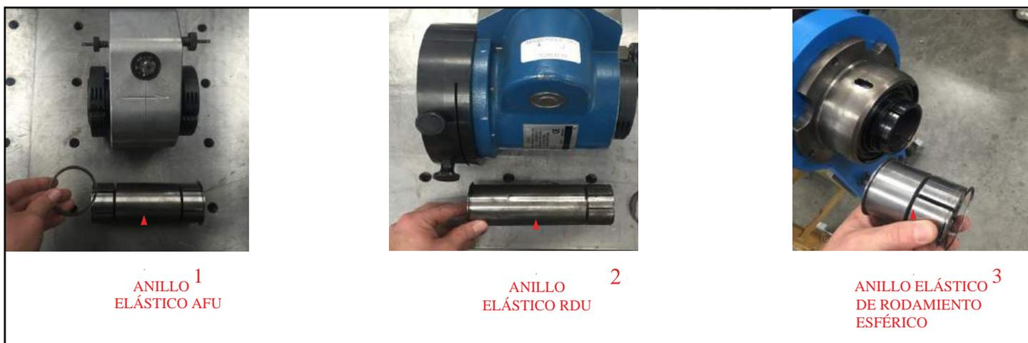
FIGURA 3-20. RETIRADA DE ANILLO ELÁSTICO
