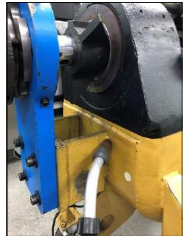
**FIGURA 3-4. CENTRAR LOS RODAMIENTOS ESFÉRICOS**
