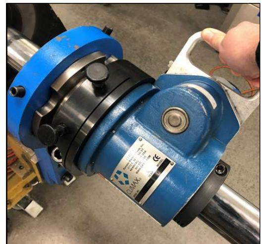
**ABBILDUNG 3-9. POSITIONIERUNG DES DREHANTRIEBS**
