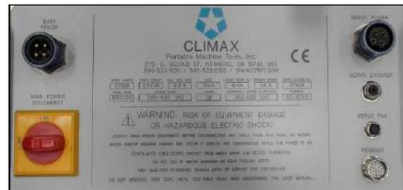
ABBILDUNG 3-15. HAUPTBEDIENFELD FÜR DEN SERVOMOTOR
