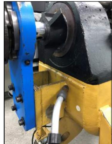
**ABBILDUNG 3-4. ZENTRIEREN DER KUGELLAGER**
