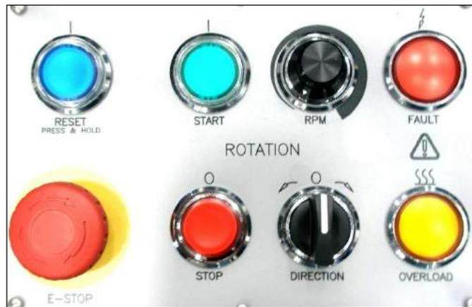
ABBILDUNG 3-16. SERVOMOTOR HÄNGESTEuerung
