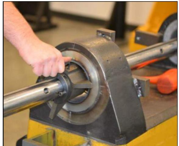
ABBILDUNG 3-2. EINSETZEN DER BOHRSTANGE
