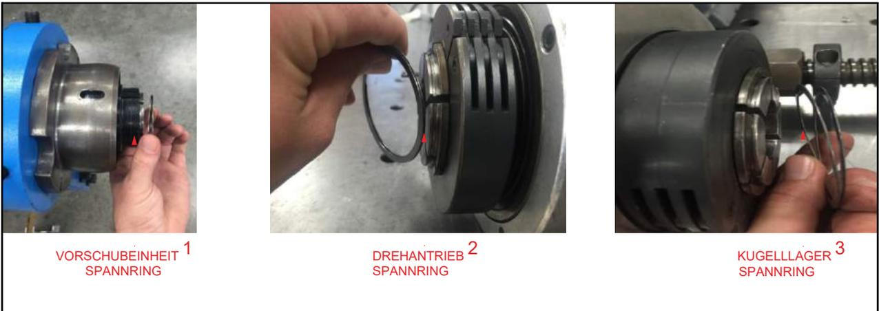
**ABBILDUNG 3-22. AUSTAUSCH DES SPANNRINGS**
