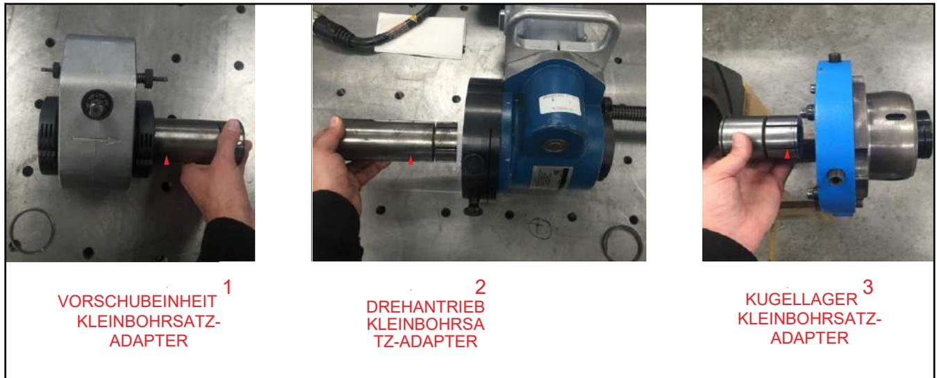
**ABBILDUNG 3-21. ADAPTEREINSATZ FÜR KLEINE BOHRUNGEN**
