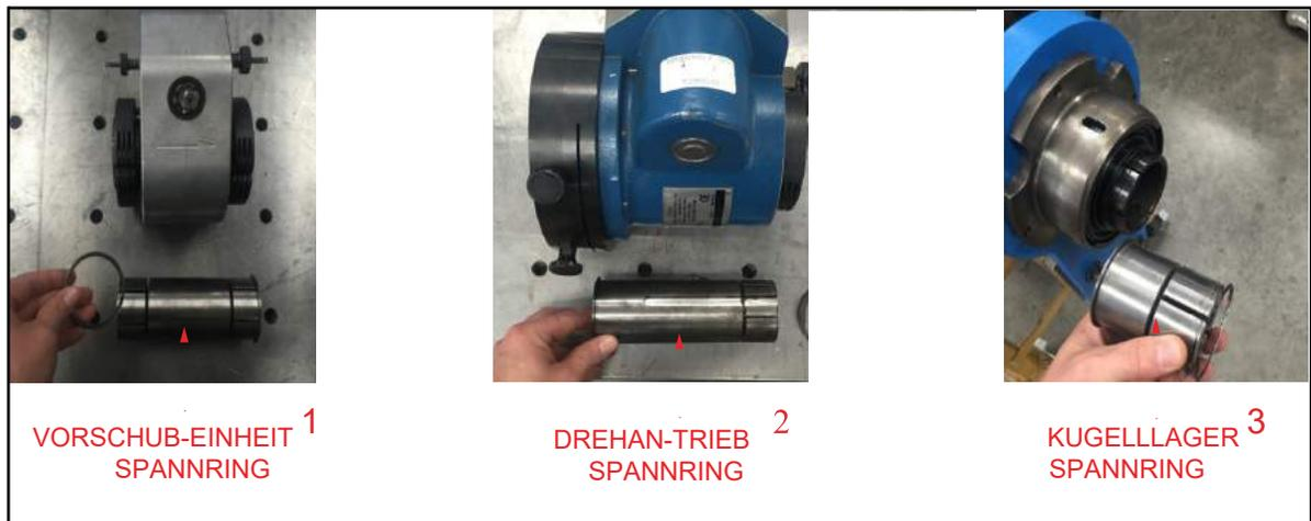
**ABBILDUNG 3-20. ENTFERNEN DES SPANNRINGS**
