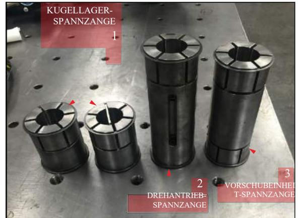
ABBILDUNG 3-18. SPANNZANGEN (BB5000 GEZEIGT)
