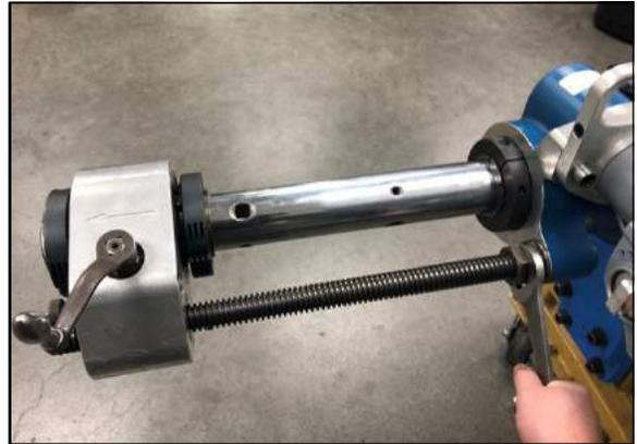
ABBILDUNG 3-10. POSITIONIERUNG DER VORSCHUBEINHEIT
