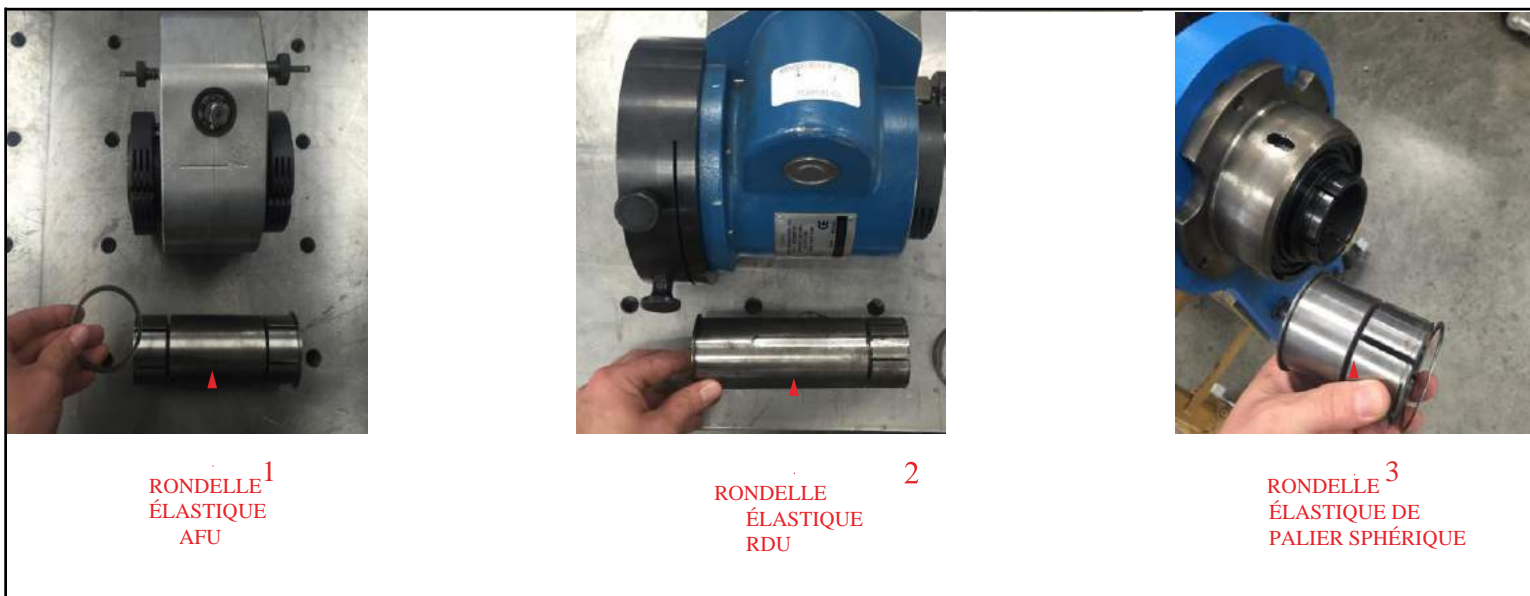
FIGURE 3-20. RETRAIT DE LA RONDELLE ÉLASTIQUE
