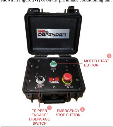
FIGURE 2-1. OPERATOR PENDANT (P/N 96374) CONTROLS
