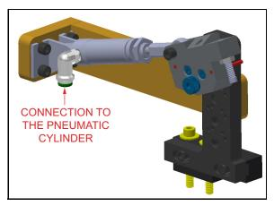
FIGURE 3-4. CONNECTION TO THE PNEUMATIC CYLINDER
