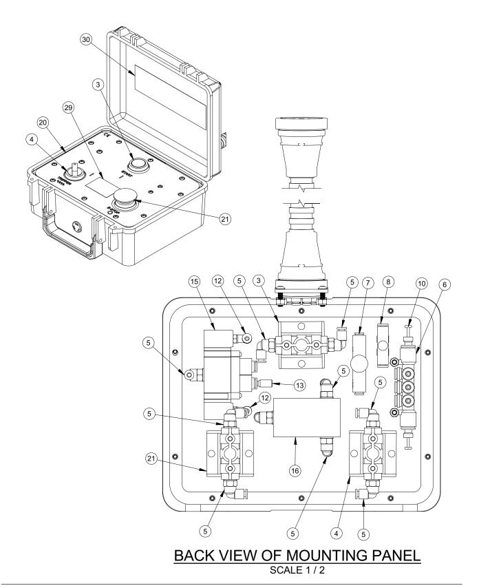
FIGURE A-3. OPERATOR PENDANT ASSEMBLY 1 (P/N 96374)
