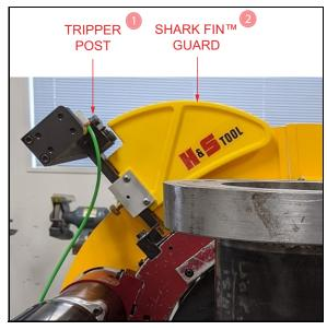
FIGURE 3-2. TRIPPER POST AND SHARK FIN™ GUARD
